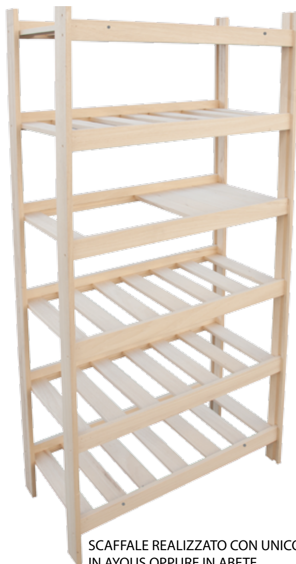
MONTAGGIO DEI PIANI CON VITI PER LEGNO MM Ø 4x50
