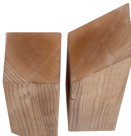
Trattamento fino in profondità sulla dimensione di MM 95x95
